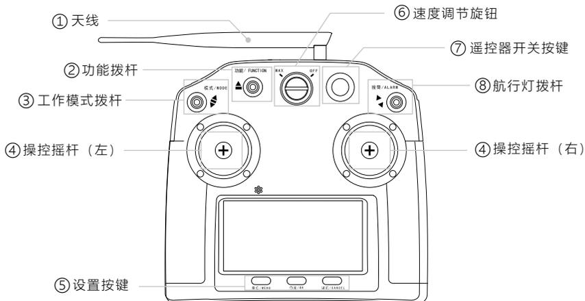
① **天线**：遥控器天线，频率900MHz。安装天线要牢固，以保证遥控信号质量。
